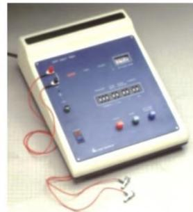
·소동물용으로서 5~10Hz 까지 Pulse rate, 0.1~1ms까지의 Pulse width, 그리고 0.1에서 6 Second까지의 Variable duration의 동등한 wave를 제공합니다. 이 기기는 operator에 의해 current pre-set가 포함된 전압을 자동으로 조절합니다.
