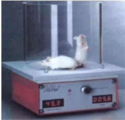
·Hot Plate는 "Hot Plate Test"에 따라 (Morphine Codeite, 기타등등)의 진통성 마취약의 빠르고 정확한 집단 검진을 하기위한 기기입니다. 고체상태가 0.1℃단계로 Plate가 모니터에 음독합니다.
