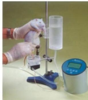
·Plethysmometer는 Volumemeter로 조작된 마이크로 컴퓨터의 중앙처리 장치로서 Rat의 발의 팽창을 정확히 측정하는 기기입니다. 이 기기의 특징은 PC에 직접 접속시켜 동물의 무게와 발의 용량을 진행시킬수 있고 더불어 프린트시킬 수 있다.
